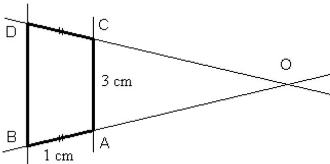
Soit [AB] le segment suivant lequel le bouchon est en contact avec la table ; le plan perpendiculaire à la table et contenant (AB) coupe le bouchon suivant le trapèze ABDC. O désigne le centre de la couronne. D'après le théorème de Thalès on a :  $\frac{OA}{OB} = \frac{AC}{BD}$  soit  $\frac{30}{31} = \frac{3}{BD}$  et  $BD = 3,1$  cm.
