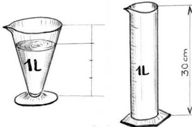
On remplit le verre aux  $\frac{4}{5}$ e de la hauteur du cône et on transvase le liquide du verre dans l'éprouvette.
