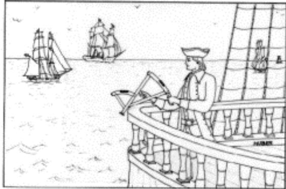
Pour effectuer la mesure, l'observateur tournait le dos au soleil et maintenait l'instrument dans un plan vertical. Ses rayons passaient à travers la fente de l'arc de cercle supérieur et venaient éclairer une fente horizontale située en A à l'extrémité de la baguette. Dans le même temps, l'observateur visait par la fente de l'arc de cercle inférieur l'horizon à travers cette même fente.
