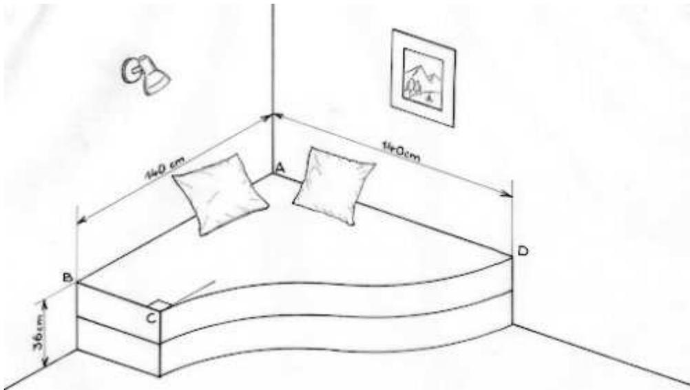
Pour que les deux parties de ce lit se complètent parfaitement, la courbe CD est constituée de deux arcs de cercles. La tangente à la courbe en C est perpendiculaire au côté BC.
